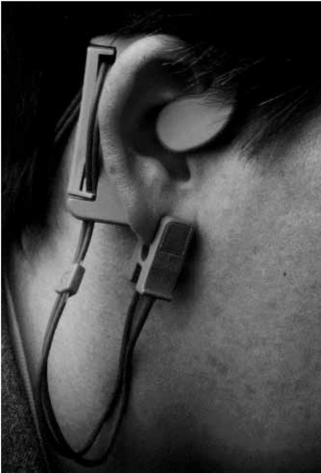
**Fig. 27.** HP M1194A clip sensor.
